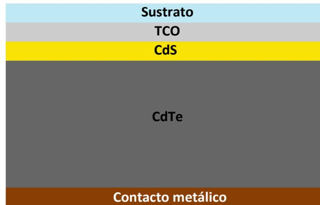
Configuración típica de una celda CdTe/CdS.
