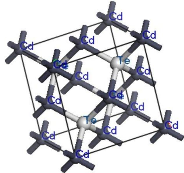
Estructura cristalina de CdS (izquierda) y CdTe (derecha), elaboradas usando el software Materials Studio 4.4.
