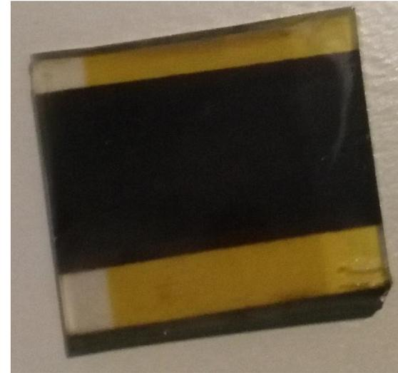
Celda solar de películas delgadas de CdTe/CdS.
